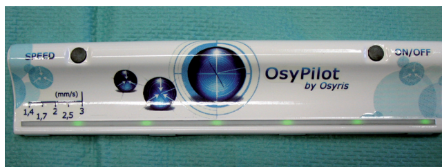
Fig. 8 – Système d'assistance à diodes lumineuses pour la traction en mode continu : Osypilot.
